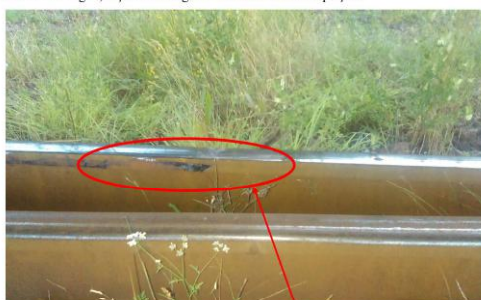
Foto nr.1 Urmele de cădere între firele căii ale roților din partea dreaptă ale osilor primului boghiu în sensul de mers de la vagonul al 11-lea
