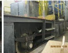
Fig. nr.2: Urmările coliziunii la DP052 Fig. nr.3: Drezina pantograf DP 052 avariată
