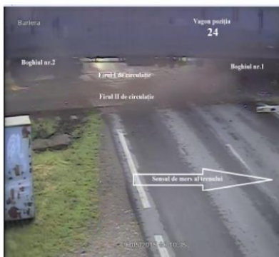
Foto nr.6 - Trecerea vagonului poziția 24 prin trecerea la nivel cu boghiurile pe cele două fire de circulație
