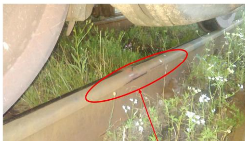
Foto nr.2 Urme de escaladare și cădere în exteriorul căii a roții din stânga de la prima osie a primului boghiu în sensul de mers de la vagonul al 11-lea
