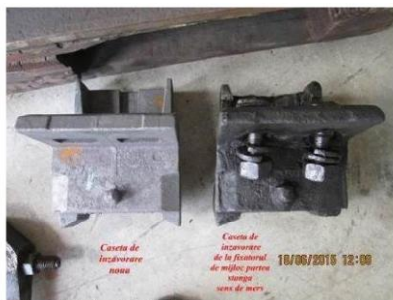
Foto nr.41 – Casete de înzăvorăre de la fixătorul de mijloc partea dreaptă sens de mers tren, montată pe contraacul drept (înzăvorăre ac curb)
