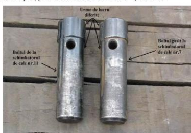
Foto nr.28 – Bolțurile montate în aceeași zi la două schimbătoare de cale diferite
