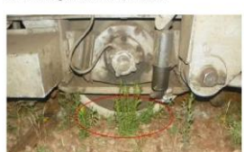
Foto 5 - roata din partea dreaptă în sensul de mers a osiei nr.4 deraiată
