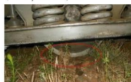
Foto 3 - roata deraiată partea dreaptă sens de mers a osiei nr.5
