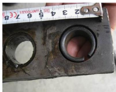
Foto nr.36 - gaura din fixătorul de vârf
