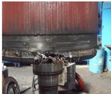
Foto nr.3 – spirele bobinajului rotorului al motorului de tracțiune nr.4
