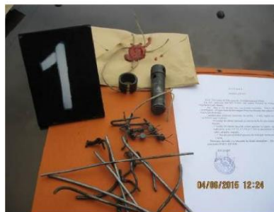
Foto nr.25 – Bolțul, bucușă și sârmele găsite în zona schimbătorului de cale nr.7
