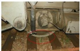
Foto 7 - roata deraiată partea dreaptă în sensul de mers a osiei nr.3
