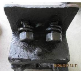
Caseta de înzăvorăre fixător de mijloc, montată pe contraacul drept (înzăvorăre ac curb) Foto nr.40
