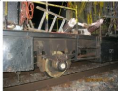
Fig. nr.2: Urmările coliziunii la DP052 Fig. nr.3: Drezina pantograf DP 052 avariată
