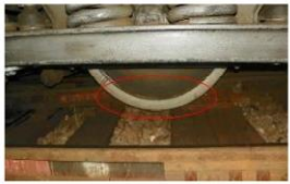
Foto 9 - roata deraiată partea dreaptă în sensul de mers a osiei nr.2
